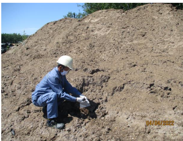
รูปที่ 3.4-12 การเก็บตัวอย่างตะกอนจากระบบบำบัดน้ำเสีย
